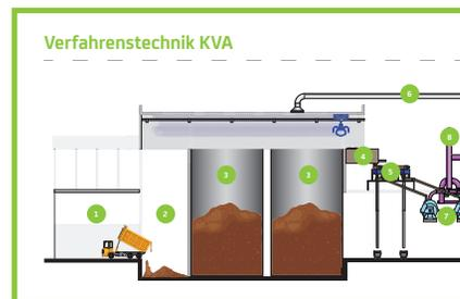
So funktioniert eine Klärschlamm-Monoverbrennungsanlage. **Verfahrenstechnik KVA.** > Seite 6
